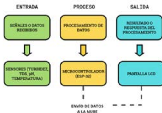
Figura 4 Diagrama de bloques del sistema embebido
