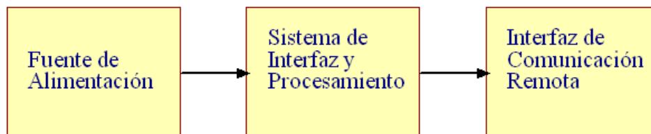
Figura 4: Componentes del sistema de telemetría
