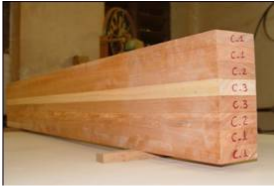
Figura 14. Viga prototipo después del encolado y del prensado de las láminas.
