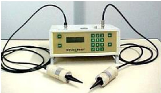
Figura 12. Equipo de ultrasonido Sylvatest con transductores de 30 kHz.
